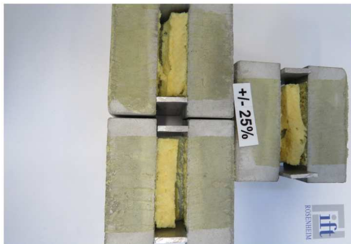
Probekörper nach Ende der zyklischen Belastung von der "Klebstoffseite"
