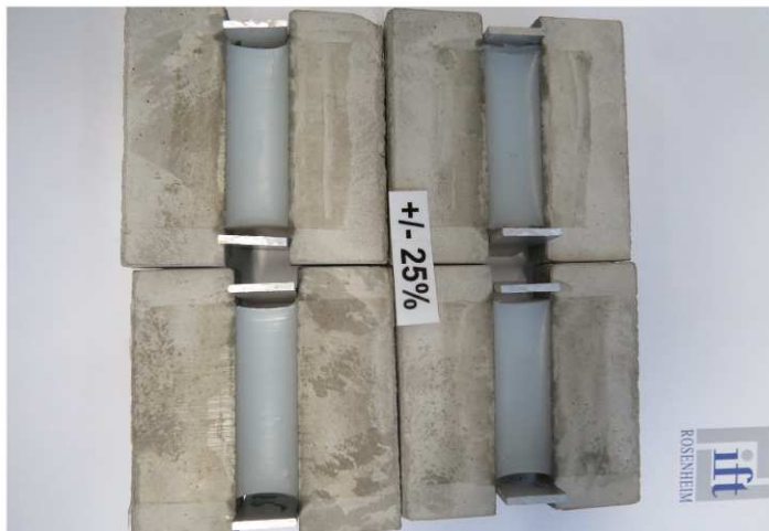
Probekörper nach Ende der zyklischen Belastung von der Rückseite
