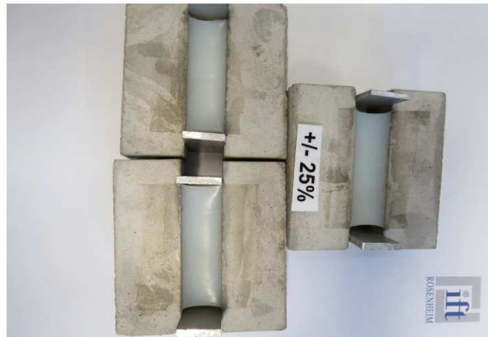
Probekörper nach Ende der zyklischen Belastung von der "Silikonseite"
