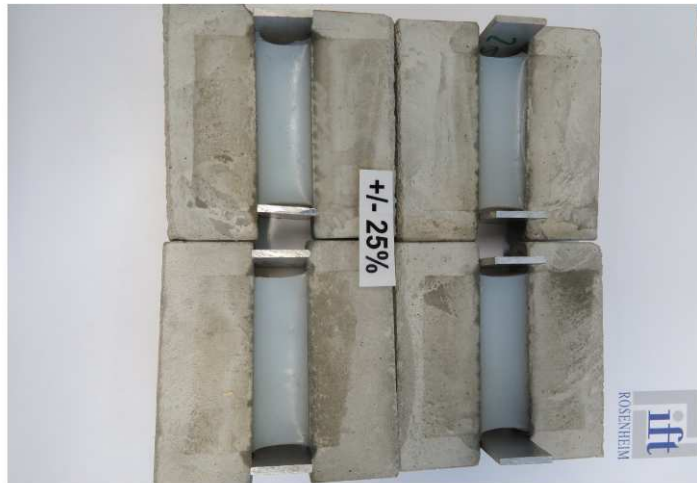
Probekörper nach Ende der zyklischen Belastung von der Vorderseite
